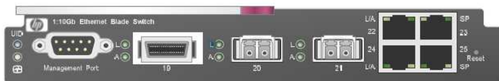
Rys. 3 Schemat fizyczny przełącznika LAN
